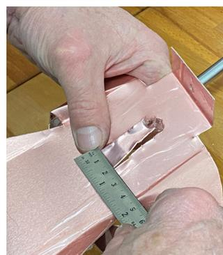
Damit die Flügel in die vorgefertigte Halterung im Blech passen, werden als Nächstes die Abstände gemessen.
