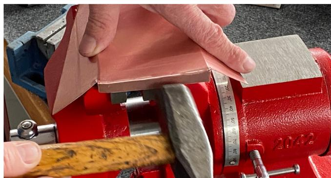
Dieser wird mit Hilfe eines Hammer nach hinten gebogen.
