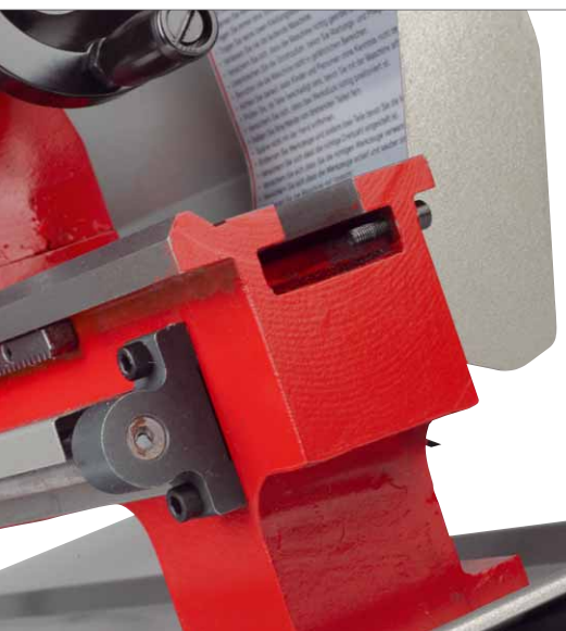
Ein Qualitätsmerkmal für Maschinen in dieser Klasse ist das gezogene Maschinenbett
