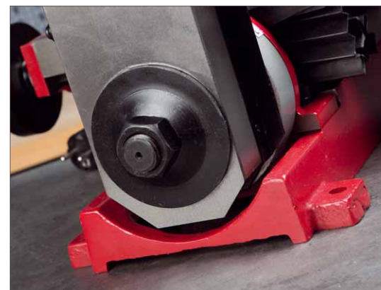
Um den Fräsmotor zur Seite zu neigen, wird die große Hauptmutter auf der Maschinenrückseite gelöst
