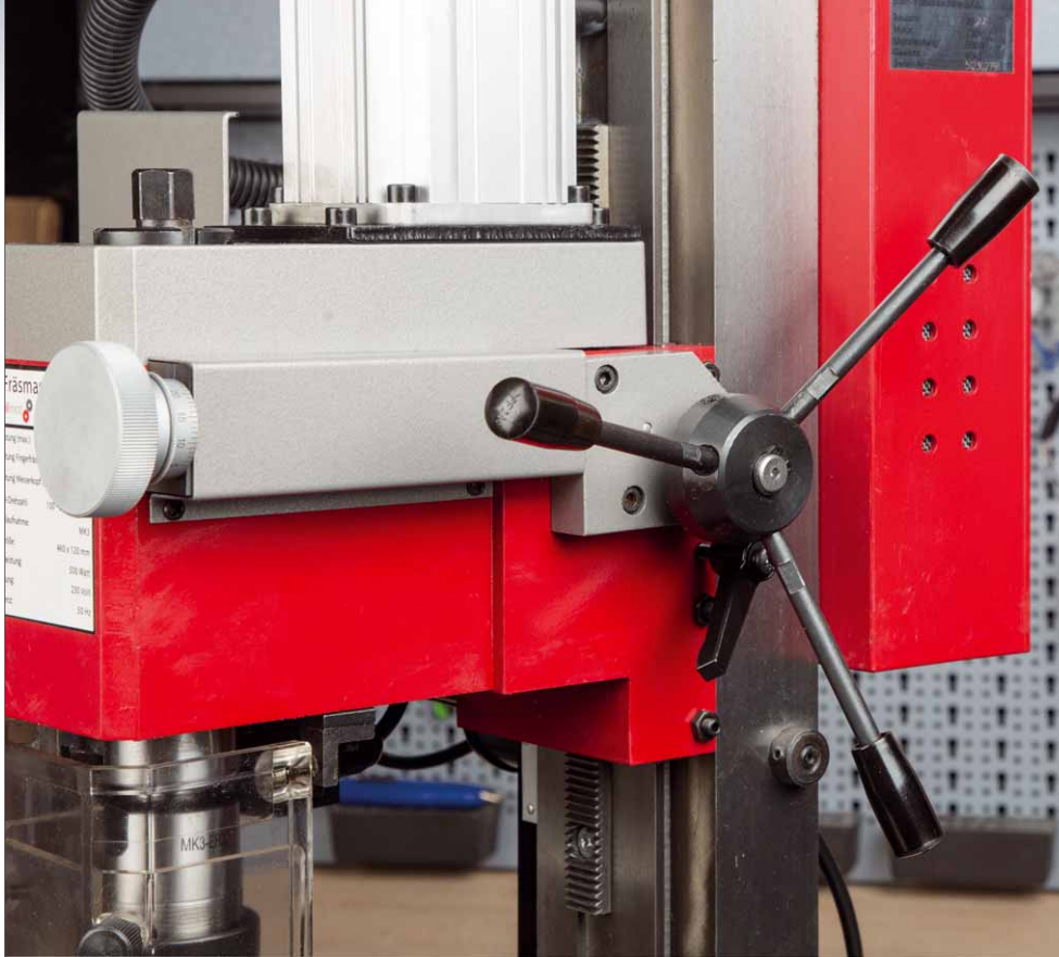
Zum Bohren kann die Bohreinheit mit der groben, dreiarmligen oder mit der feinen Vorschubeinheit vorn an der Maschine verfahren werden
