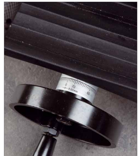
Mit diesen gut ablesbaren Skalen sind sowohl der Verfahrweg in X- und in Y-Richtung ausgestattet
