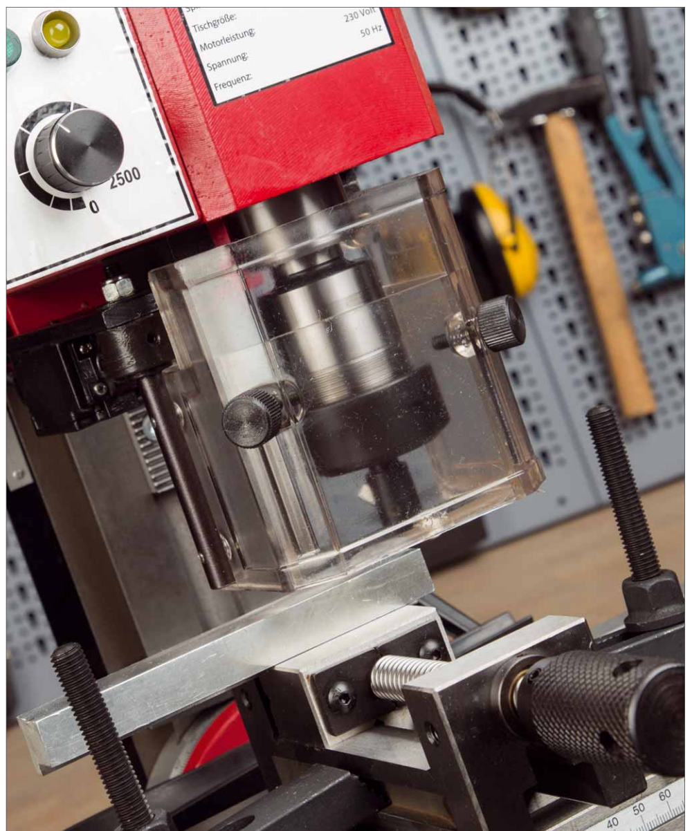
Beim Fräsen verhindert die transparente Abdeckung auch, dass sich Späne quer durch den Raum verteilen
